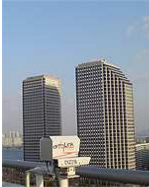
FSO оборудование M1 ARTOLINK (ООО МОСТКОМ) в Сеуле - дистанция связи 1.1 км
