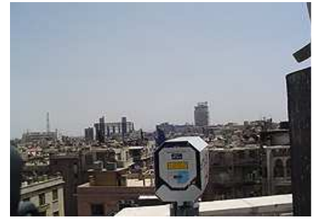
FSO оборудование M1 ARTOLINK (ООО МОСТКОМ) в Сеуле - дистанция связи 1.1 км
